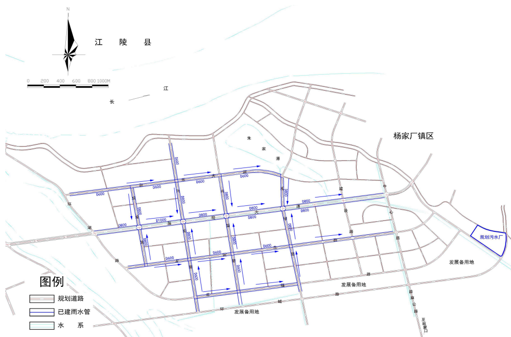
图 1.6-2 青吉工业园现有雨水管网示意图
