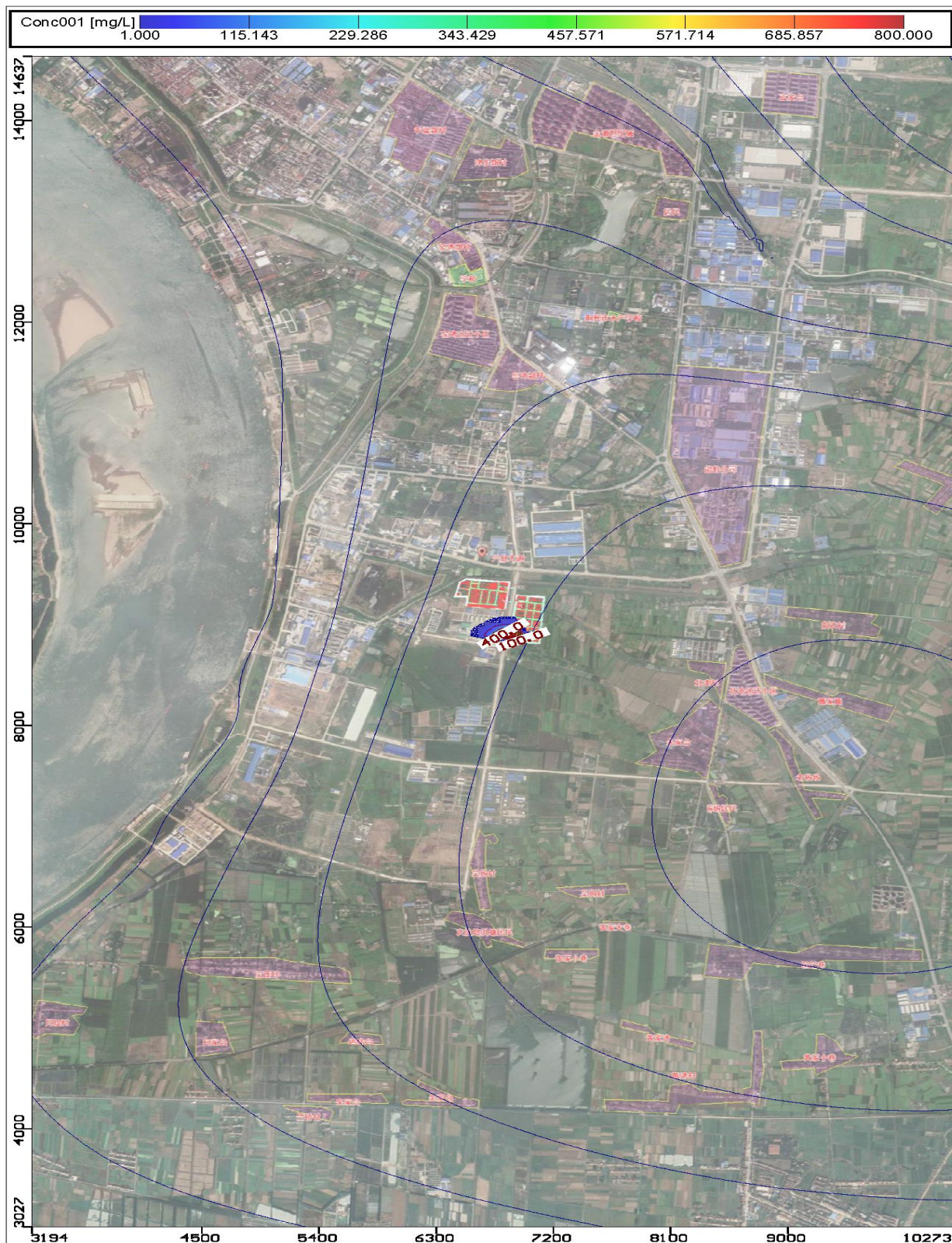
图 6-20 泄漏发生污染晕分布图 (3000 天)
