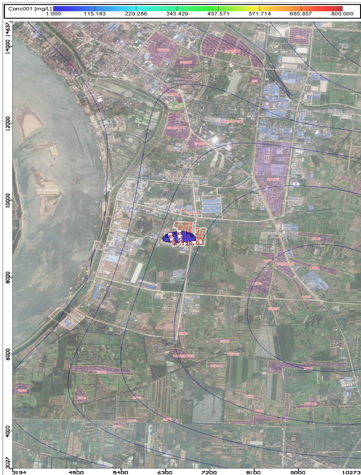
图 6-21 泄漏发生污染晕分布图 (7300 天)
